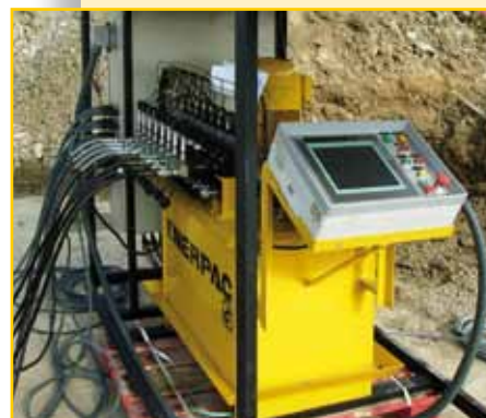
Posizionamento con controllo PLC ▼
