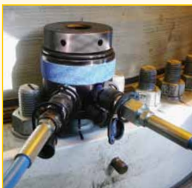
▲ Tensionatori idraulici serie GT per il tensionamento di bulloni di lame.
