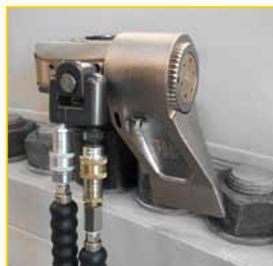
▲ La chiave S3000P viene impiegata per collegare i segmenti di impianti eolici.
